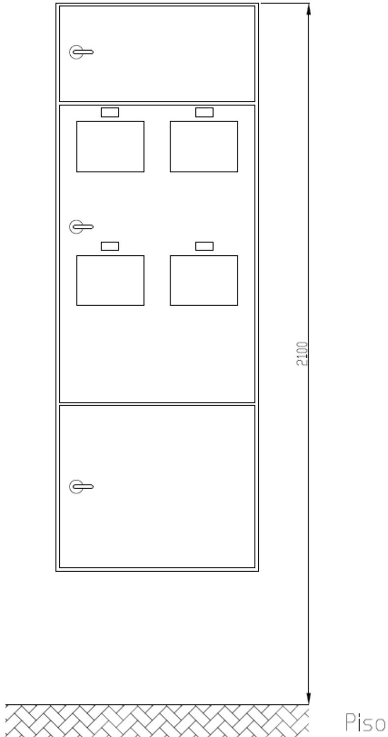
Quando instalada em pedestal a caixa deverá ter uma sobre tampa na parte de trás com no mínimo 70 mm de espessura para a proteção dos condutores do circuito alimentador até a base de alvenaria.
